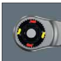
Denture double, angle de reprise max. 5°
